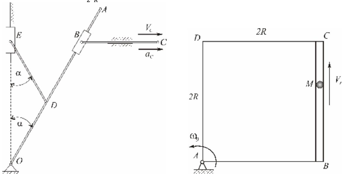
5. Kvadratna pločica ABCD stranice  $2R$ , obrće se oko nepokretne ose koja prolazi kroz tačku A, konstantnom ugaonom brzinom  $\omega$ . Duž žleba BC kreće se tačka M, jednoliko ubrzano, pri čemu se relativna brzina menja po zakonu  $V_r(t) = \frac{5}{4}R\omega^2 t + 2R\omega$ . U početnom trenutku tačka je bila u položaju B. Odrediti veličine absolutne brzine i absolutnog ubrzanja pokretne tačke u položajima B i C.
