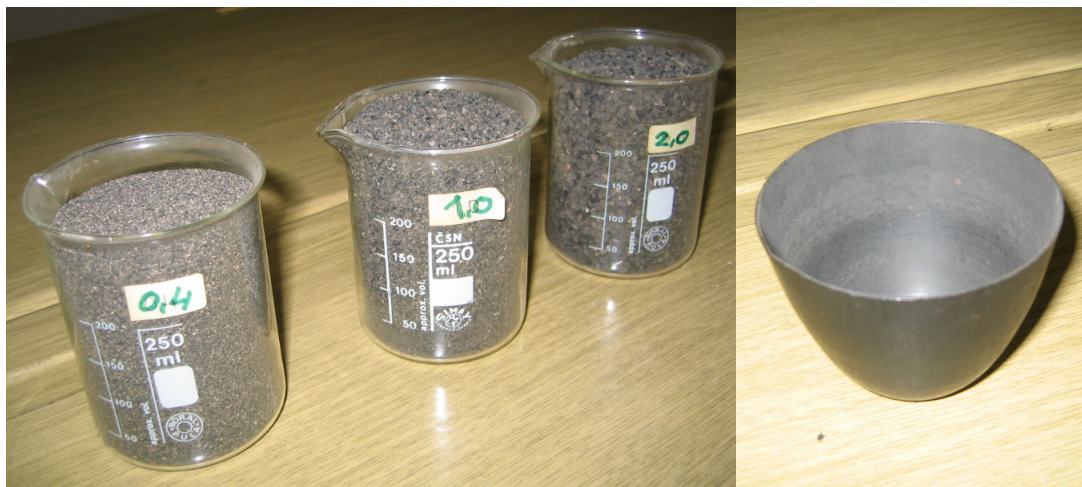
Slika 2. Merenje nasipne gustine: uzorci goriva (levo) i sud zapremine 200 ml (desno)
