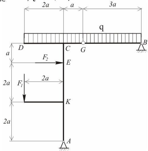
**2.** Za okvirni nosač sa Gerberovim zglobom prikazan na slici analitički odrediti reakcije veza i nacrtati statičke dijagrame ako je  $a = 1 [m]$ ,  $F_1 = F_2 = 3 [kN]$ ,  $q = 2 \left[ \frac{kN}{m} \right]$ .
