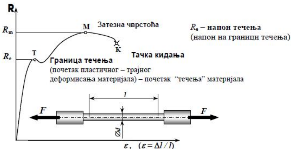
Slika 2. Dijagram zatezanja epruvete ( R - \varepsilon )
