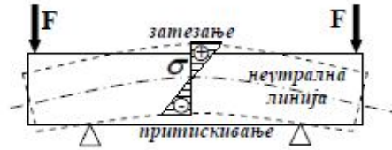
Slika 6. Savijanje grede i konzole silom
