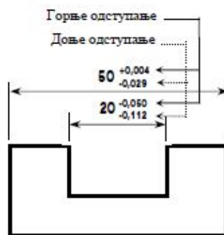
Slika 7. Numeričko prikazivanje tolerancija na crtežu
