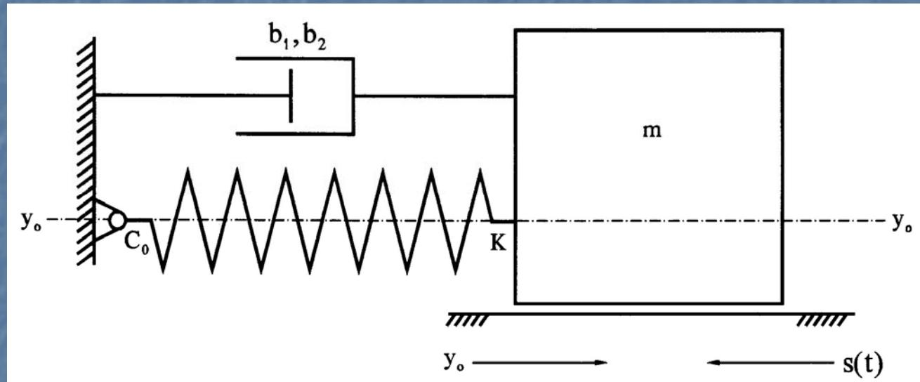
Ako se zanemari sopstvena masa opruge, a kretanje je prigušeno otpornom silom:  $F_w = b_1 \cdot \dot{y}_o + b_2 \cdot \dot{y}_o^2 = -(b_1 \cdot \ddot{s} + b_2 \cdot \dot{s}^2)$  diferencijalna jednačina kretanja biće :  $m \cdot \ddot{y}_o + c_s \cdot y_o + b_1 \cdot \dot{y}_o + b_2 \cdot \dot{y}_o^2 = 0$
