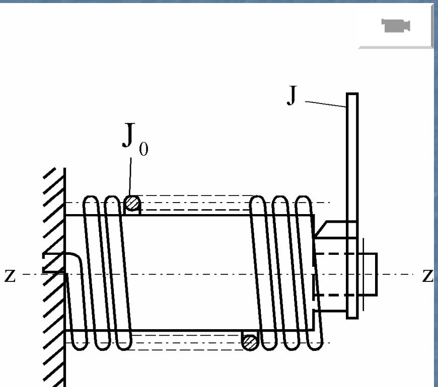
$$J \cdot \ddot{\varphi}_0 + c_\varphi \varphi_0 = 0$$
