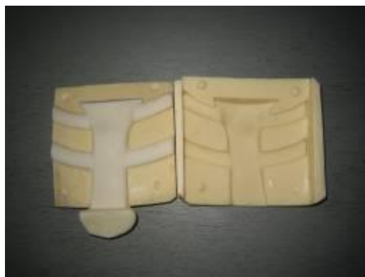
Слика 12. Имплантат изливен у калупу пре завршне обраде
